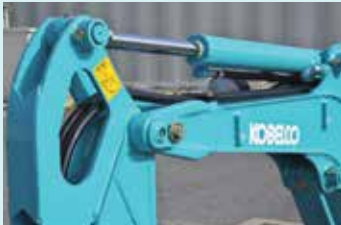
Slangen bakcilinder lopen door graafarm
